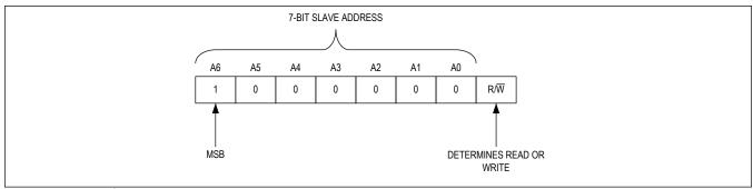
Figure 8. DS2485 I<sup>2</sup>C Slave Address
