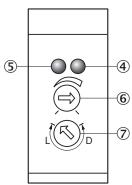
④ 橙色 LED 指示灯: 开关量输出激活 ⑤ 绿色 LED 指示灯: 状态指示灯 ⑥ 灵敏度调节器 270°
