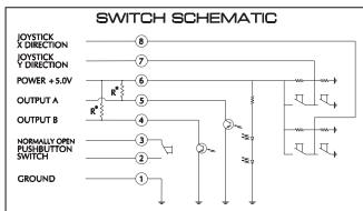
\*EXTERNAL PULL-UP RESISTORS REQUIRED FOR OPERATION (2.2k\(\Omega\)).
