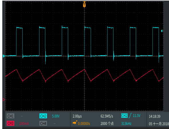
SW 脚与电感电流工作波形
