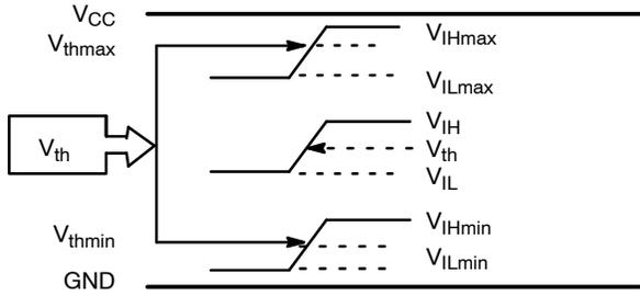
Figure 7.  $V_{th}$  Diagram
