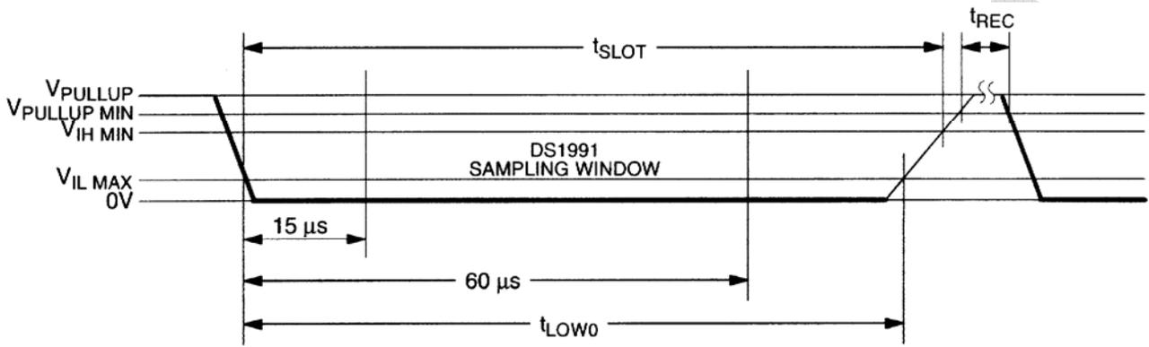
$$60 \mu\text{s} < t_{\text{LOW0}} < t_{\text{SLOT}} < 120 \mu\text{s}$$
