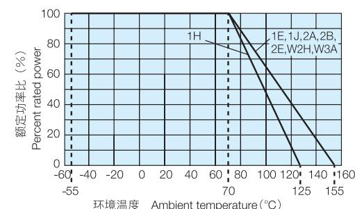
在环境温度70°C以上使用时，应按照上图负荷特性曲线，减小额定功率率。
