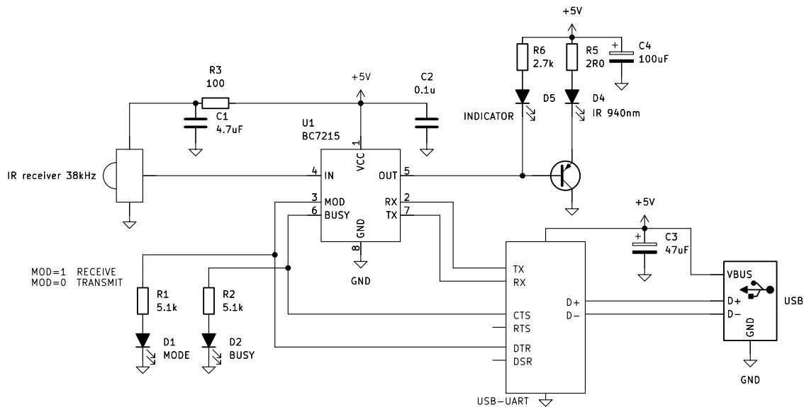
(与电脑连接时，请注意所使用的系统驱动应支持 USB-UART 芯片的硬件流控制，否则可能会造成 BC7215 UART 缓冲区溢出从而引起长数据发送失败)
