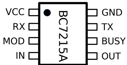
BC7215/BC7215A(以下统称 BC7215)是一款可支持几乎所有常见红外遥控格式的专用编/解码(收发)芯片，自动识别红外遥控信号的编码格式，可以支持 99.5%以上的空调遥控器和 98%以上的影音及其它设备红外遥控器。该芯片集红外遥控的解码(接收)和编码(发射)于一体，单片即可完成红外遥控的解码和编码发射功能。
