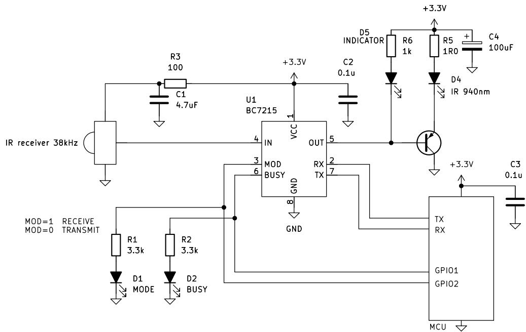
红外发射管通常要求比较大的峰值电流，才能达到较远的传输距离，很多红外发射管可以承受高达1A的瞬间电流，发射时红外发射管工作电流（有载波情况下），可达200mA以上，因此在电源设计时需要给予考虑。
