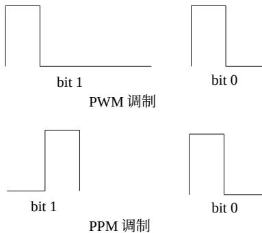
调制的类型决定一个关键因素，即数据发送的顺序。红外数据是串行数据，不同的遥控器格式规定了不同的数据排列顺序，是高位 MSB 先传送还是低位 LSB 先传送。BC7215 对所有采用脉冲宽度 PWM 编码的红外信号，均按照低位 LSB 在前进行解码，与该格式最常见的遥控芯片 NEC 编码所使用的方式相同。而对于 PPM 格式，则按照高位 MSB 在前进行解码，同该格式最常见的 RC5 编码遥控芯片。请参见后文《数据位对齐方式》部分。
