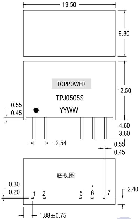
单位：毫米，未标注之公差：±0.25 毫米，间距：2.54 毫米
