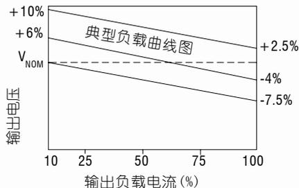
输出电压精度曲线图仅3.3V输入, 3.3V输出
