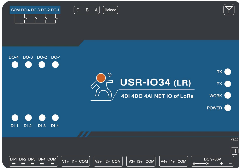
图 10 硬件接口示意图
