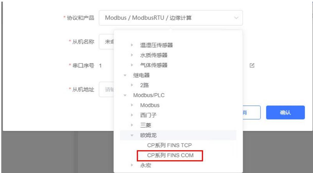
2. 选择连接 PLC 的串口号和 PLC 的站地址，输入错误可能导致采集失败。确认无误后点击确认即可。
