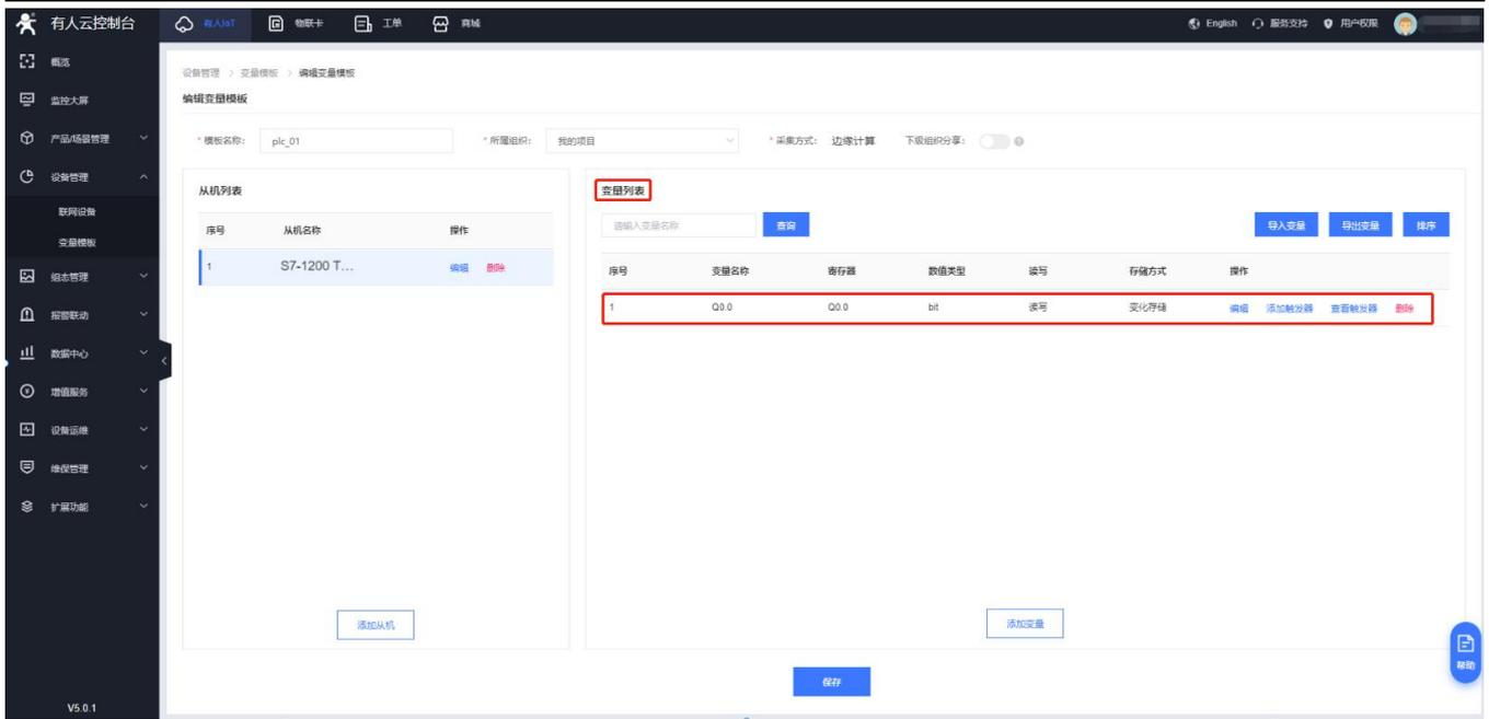
4. 修改 PLCNET210 的 LAN 口参数，使得 LAN 口和 S7-1200 的网口处于同一个网段，设置完成后重启网关。
