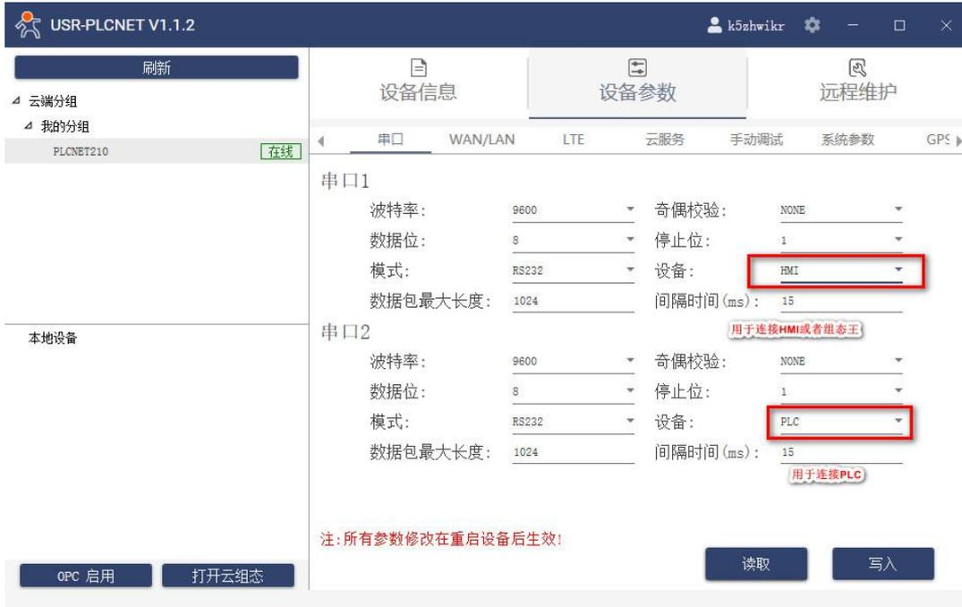
设置完成后点击写入，然后重启 PLCNET210。确保串口接线正确，即可从云端和组态王软件同时查看 PLC 数据。
