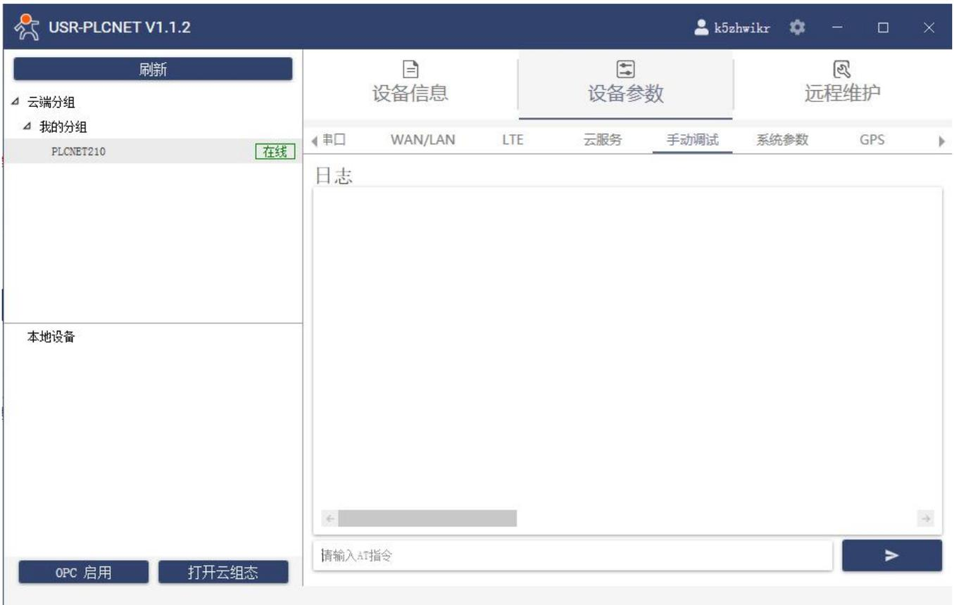
通过设备参数→系统参数，可以读取和设置时区，以及控制设备重启。
