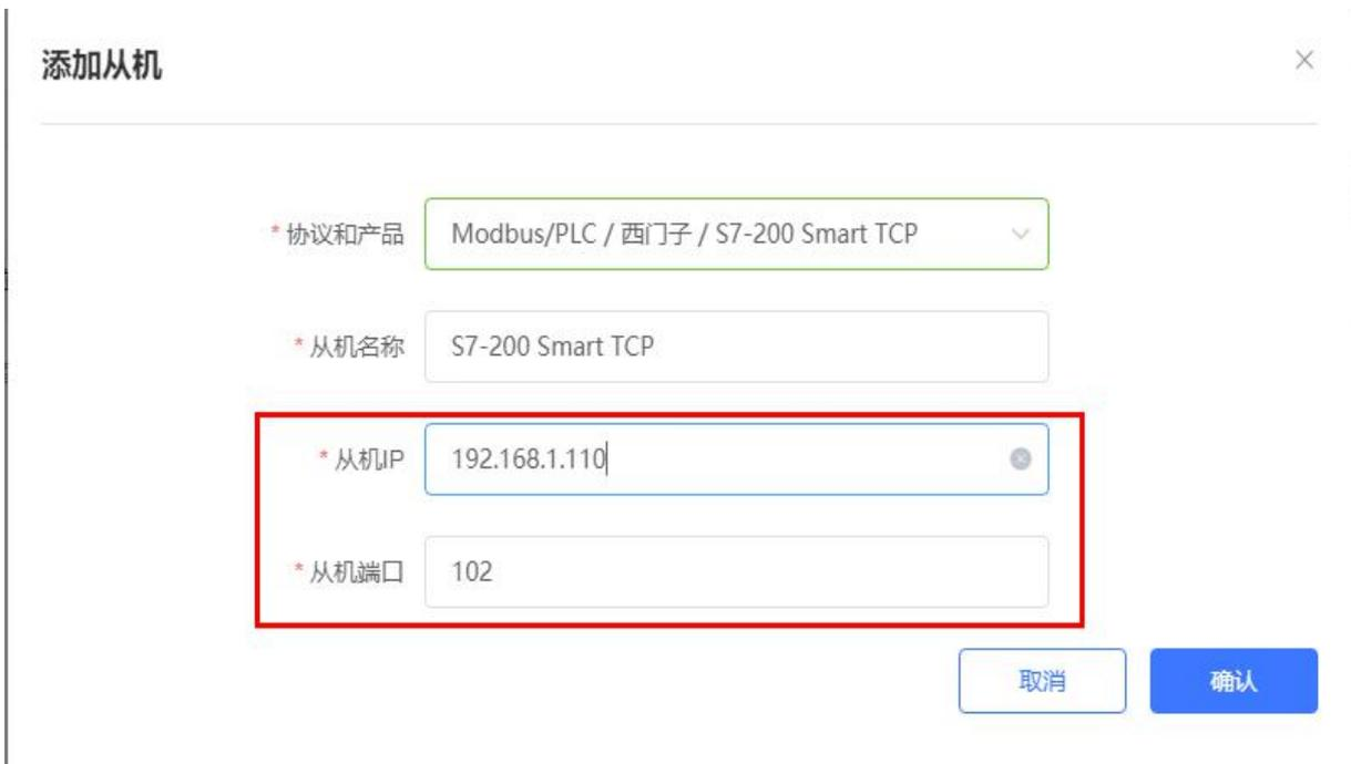
3. 添加需要采集的数据节点，注意 PLC 内部寄存器的实际地址范围，以及节点的读取方式。
