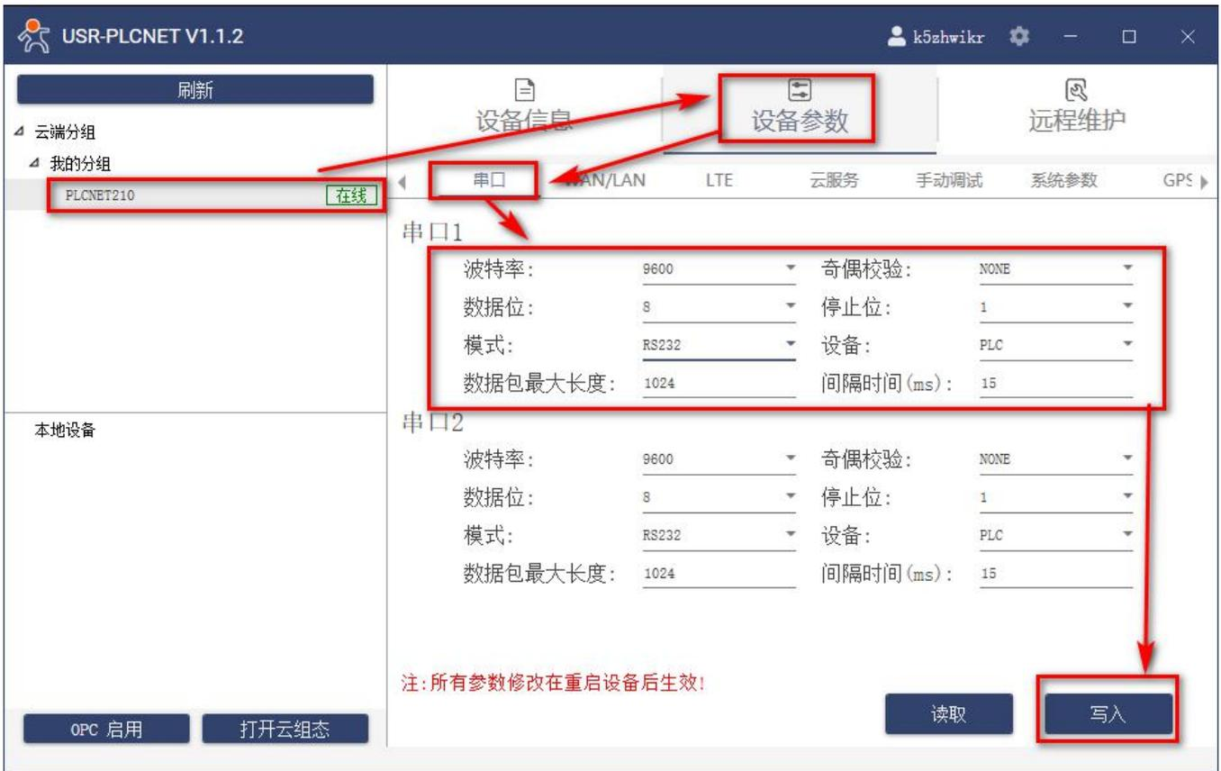
5. FX1N PLC 通过串口线连接至 PLCNET210，此时通过云端即可查看 PLC 数据。
