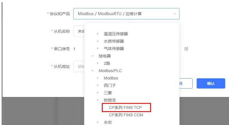
2. 设置 PLC 的 IP 地址以及端口号，输入错误可能导致采集失败。确认无误后点击确认。
