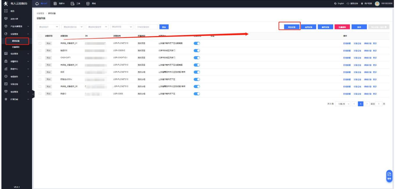
b) 点击设备管理 添加设备，填写网关设备名称、归属项目，输入设备 MAC 和 SN，配置设备数据模板或者选择已有模板。
