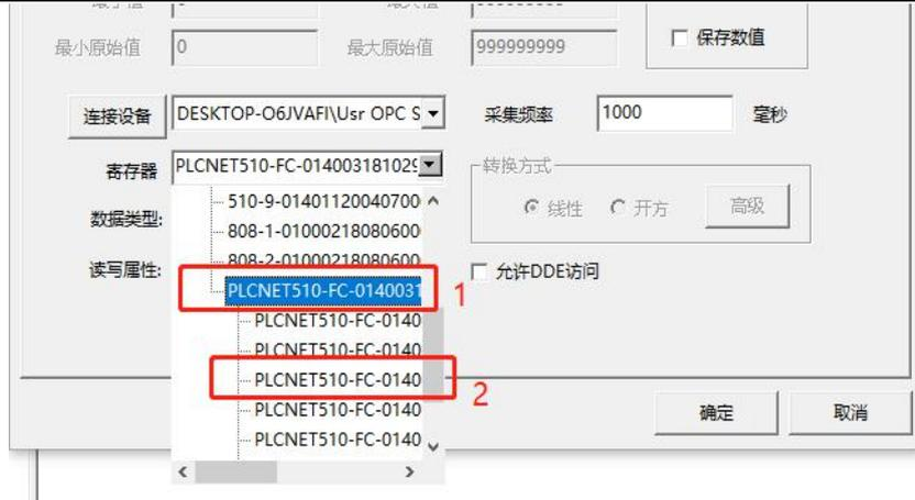
图中框 1 表示该 OPC 账号下的设备名称，因在 OPC 软件内勾选了 OPC 节点名称包含设备 SN 选项，所以本示例的设备名称以及节点都包含设备的 SN 码。双击设备名称可以显示框 2 表示的设备包含的节点信息，点击此节点信息即可将此节点添加到组态王软件的寄存器下，此时组态王的这个节点便和有人云端的同名称节点关联，以此可以实现云端和组态设备同时监控。
