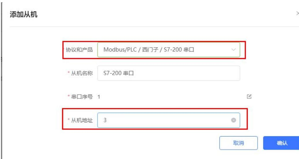
3. 添加需要采集的数据节点，注意 PLC 内部寄存器的实际地址范围，以及节点的采集方式。
