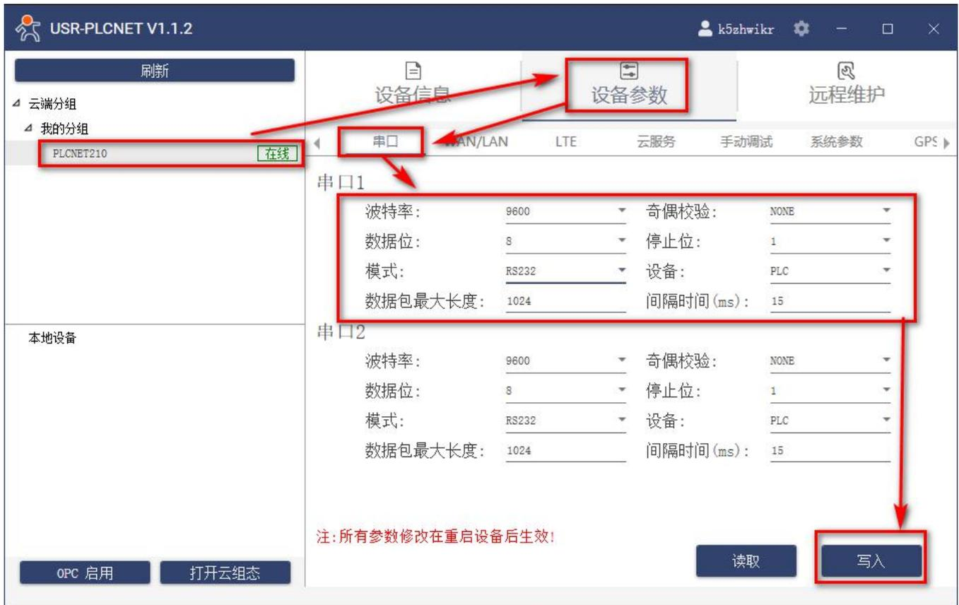
5. S7-200 PLC 通过串口线连接至 PLCNET210，此时通过云端即可查看 PLC 数据。
