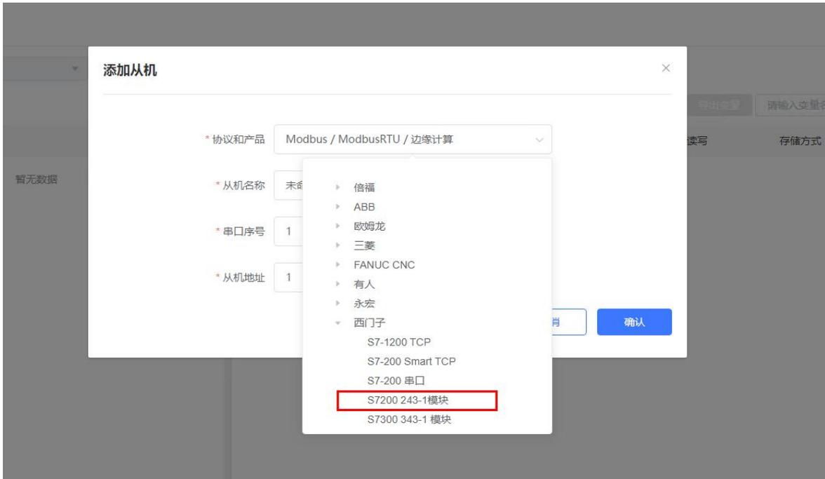
2. 设置 S7-243-1 的 IP 地址以及端口号，输入错误可能导致采集失败。确认无误后点击确认。
