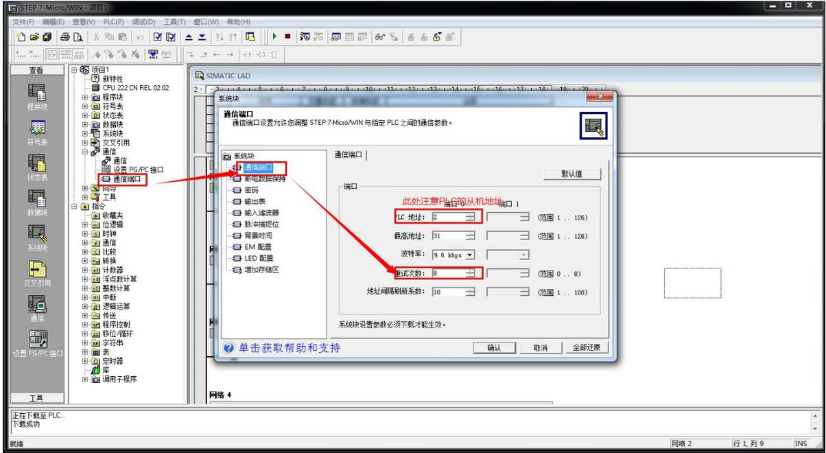
点击项目列表中的“通信”->“设置 PG/PC 接口”，通信串口选择虚拟 COM 口，并选择调制解调器模式。
