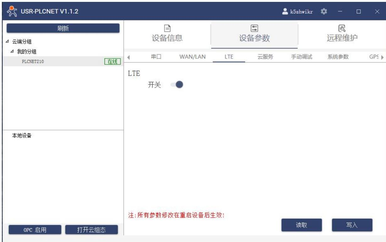
通过设备参数→云服务，可以读取 PLCNET210 的云端域名以及端口号，也可以进行相关参数的配置。
