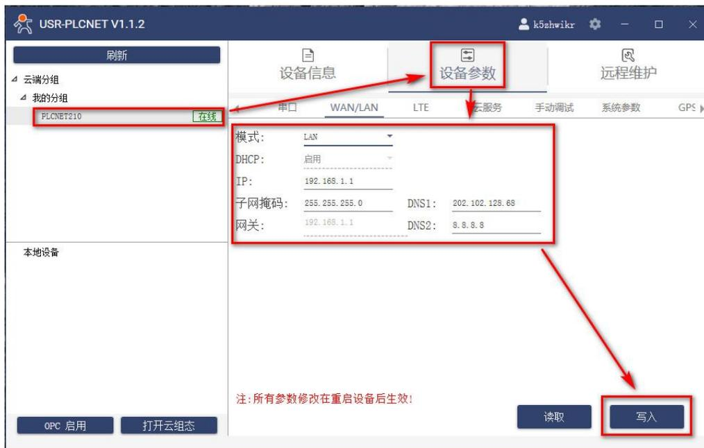
5. CP1H PLC 通过网线连接至 PLCNET210 的 LAN 口，然后即可在云端查看 PLC 数据。
