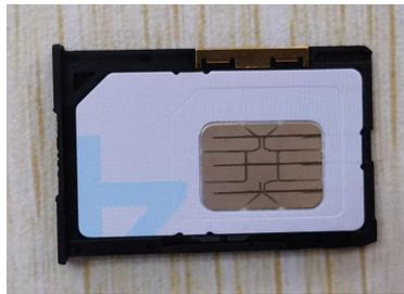
设备插入 SIM 卡，即可通过 4G 联网。若需要关闭 4G 上网，可以通过内置网页或者 USR-PlcNet 软件进行操作。
