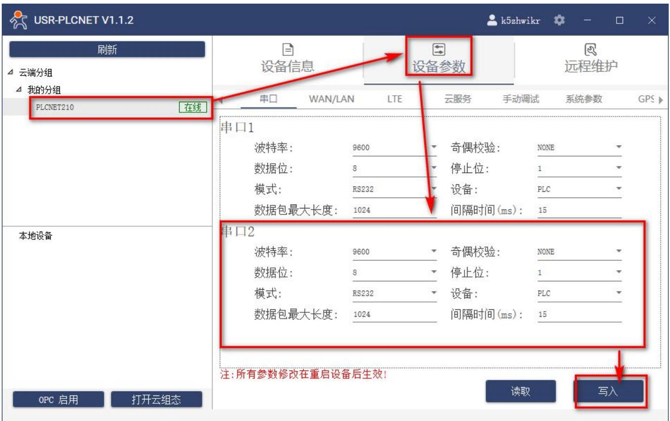
5. FBS-20MCT2-AC PLC 通过串口线连接至 PLCNET210，此时通过云端即可查看 PLC 数据。
