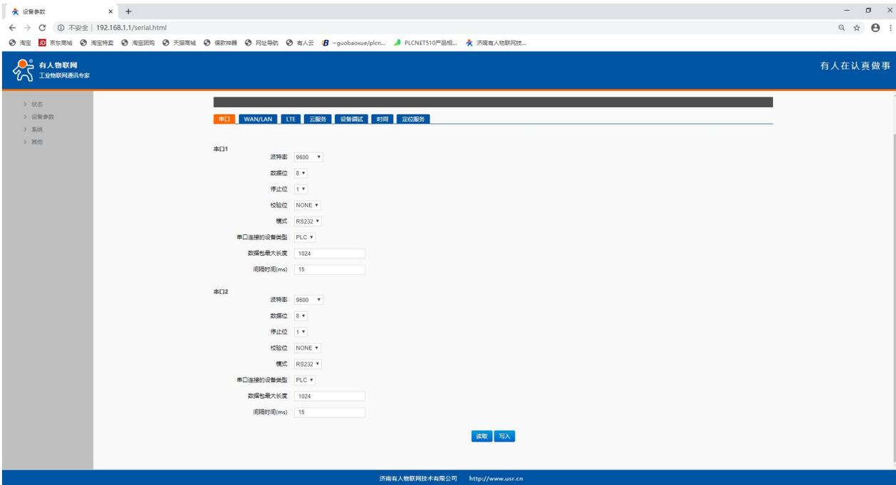
通过设备参数→设备状态→WAN/LAN，可以读取或者写入 PLCNET210 的 WAN/LAN 口参数。
