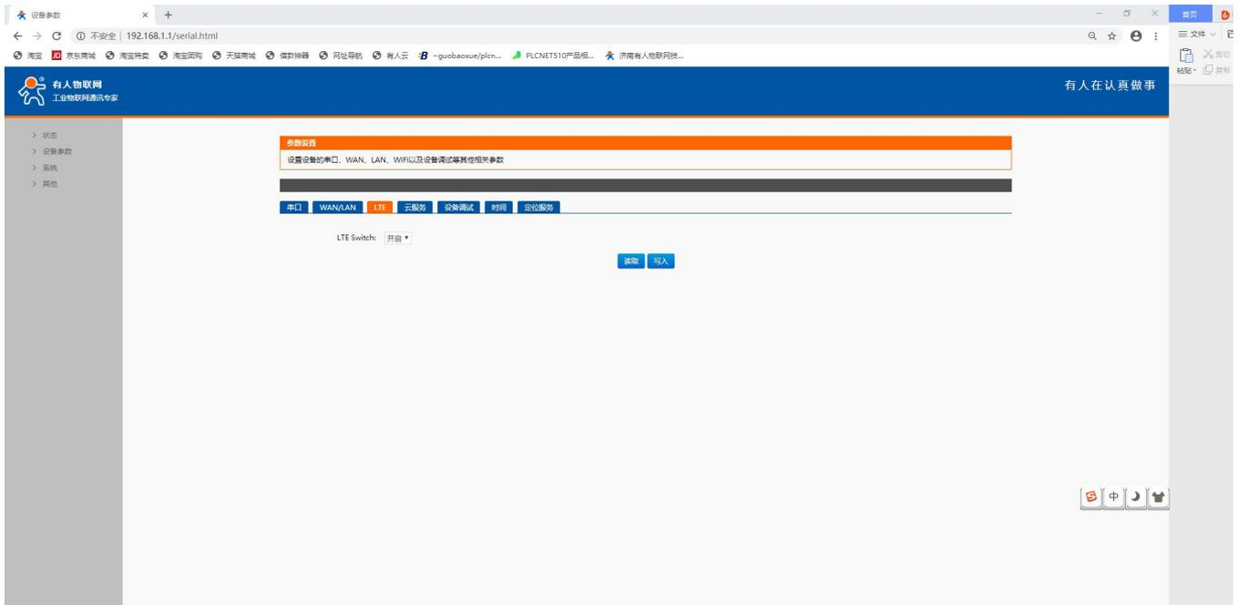
通过设备参数→设备状态→云服务，可以读取或者更改连接云端的域名和端口号。
