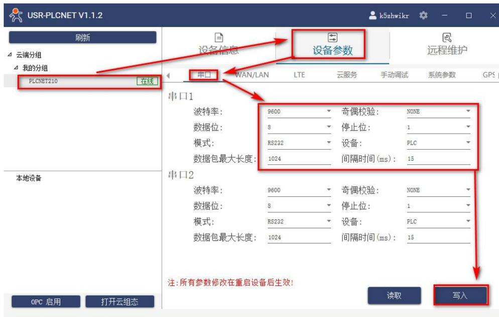
修改完成后在上位机中点击设备参数→系统参数→设备，设备重启后串口参数生效。
