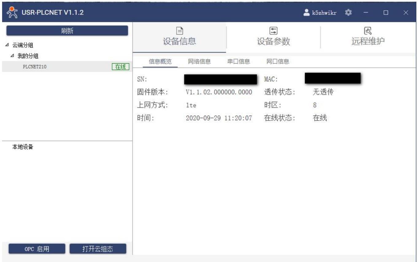
通过设备信息→网络信息，可以查看 PLCNET210 的服务器连接状态及上网方式。
