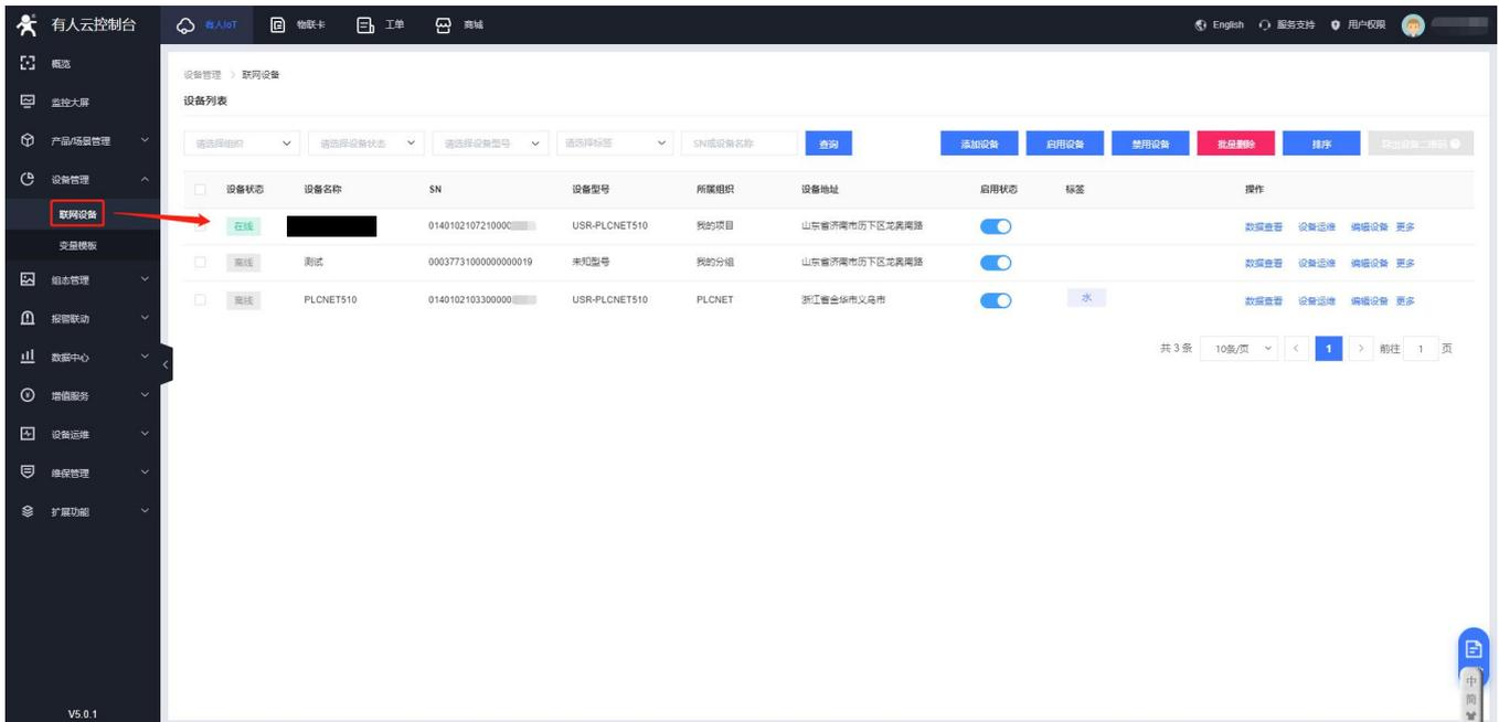
2. 修改 PLCNET310 的 LAN 口网段，使得 LAN 口和 S7-243-1 模块的网口在同一网段。
