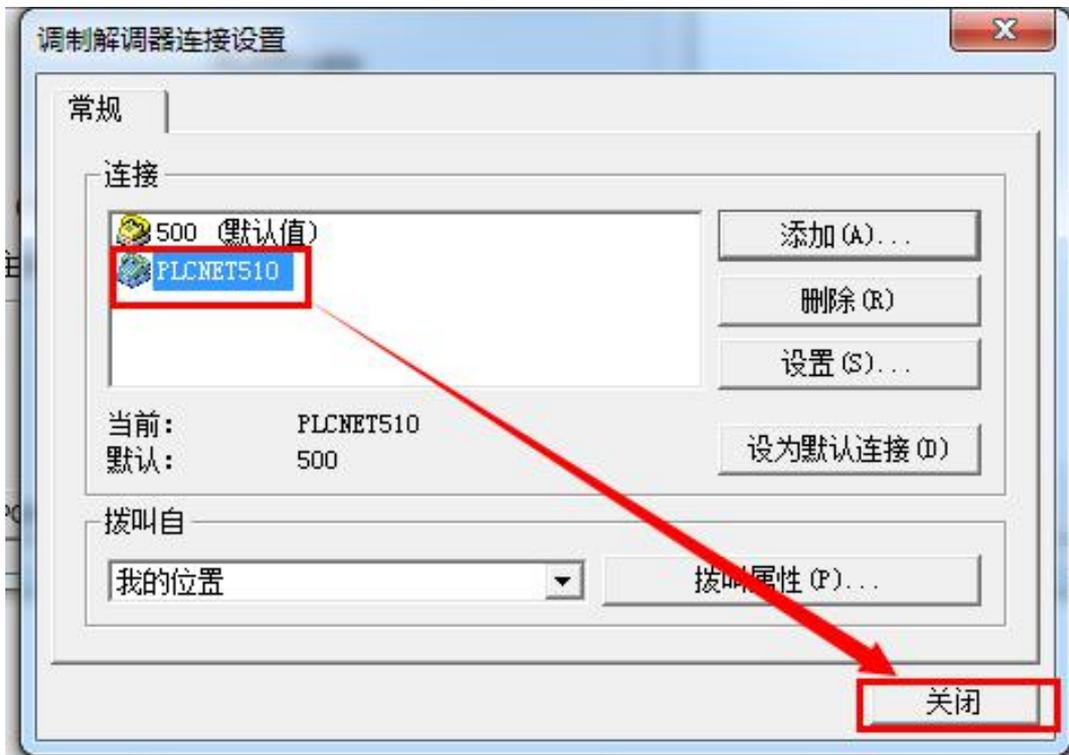
点击连接，完成软件与调制解调器的连接；连接完成之后此页面自动关闭；
