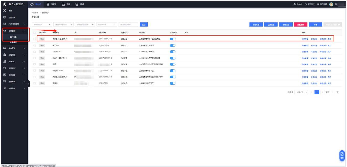
可以通过数据节点右端的更多→主动采集，来主动查询 PLC 内部寄存器数据。
