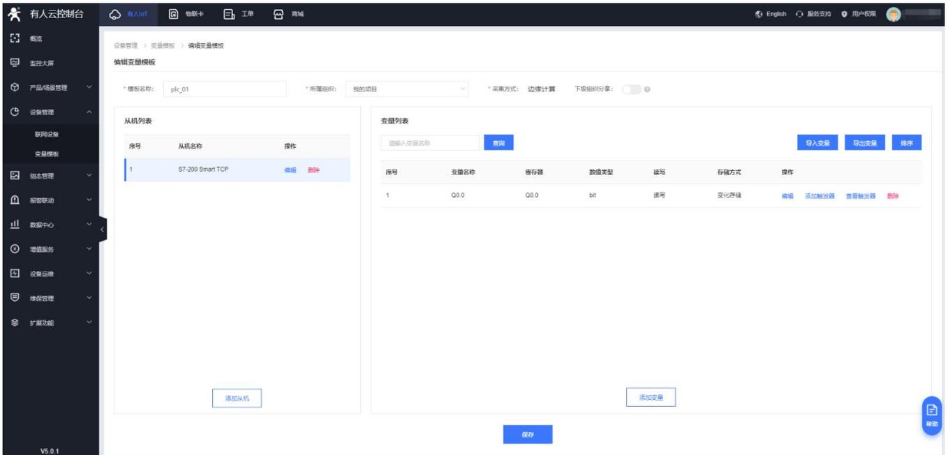
4. 修改 PLCNET210 的 LAN 口参数，使得 LAN 口和 S7-1200 的网口处于同一个网段，设置完成后重启网关设备。
