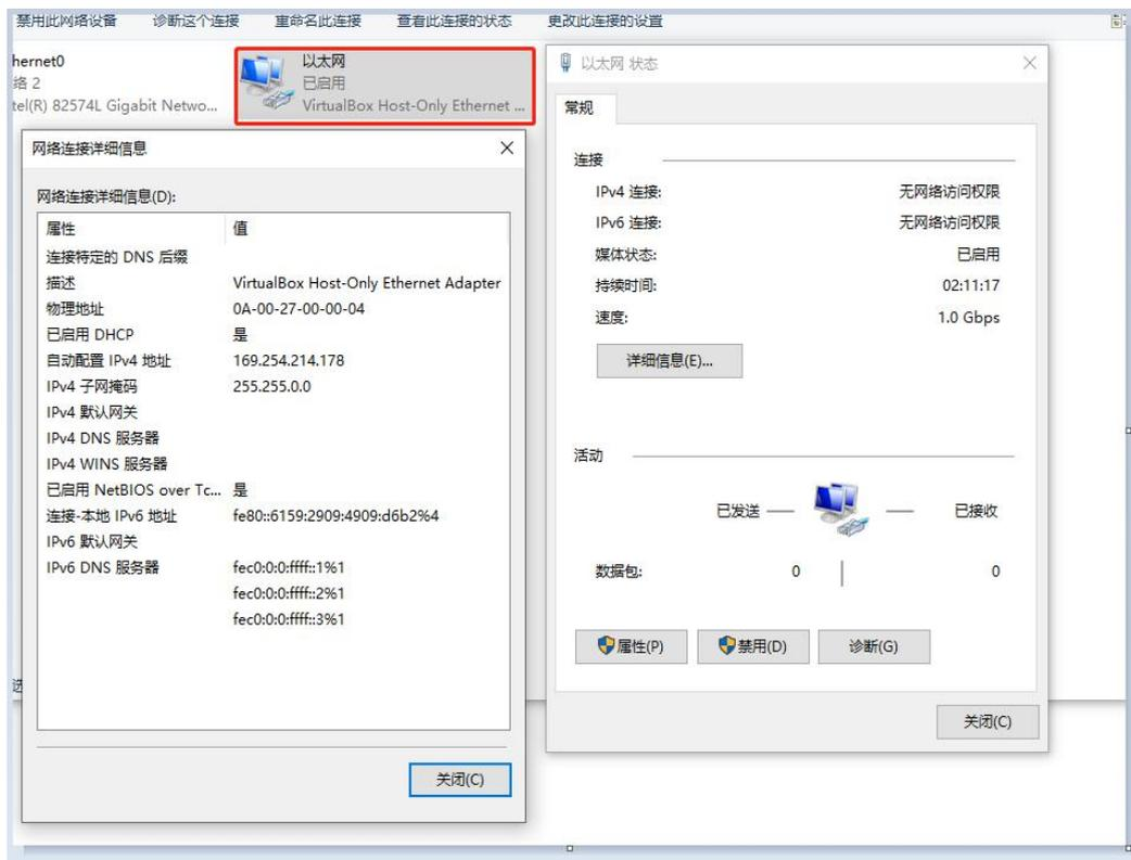
此网卡是 PLCNET210 自动分配的，和 PLC 处于同一个网段，相当于和 PLC 网线直连。
