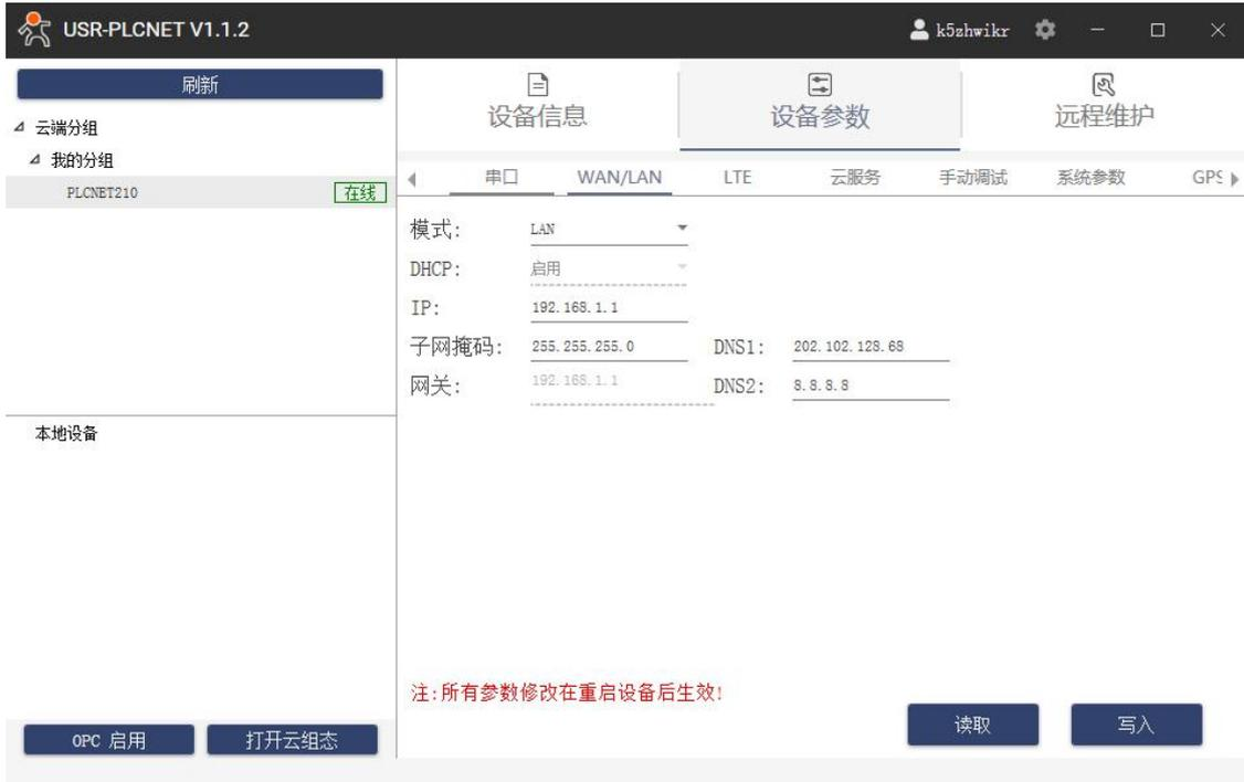
通过设备参数→LTE，可以读取 PLCNET210 的 4G 开关状态，也可以进行相关参数配置。
