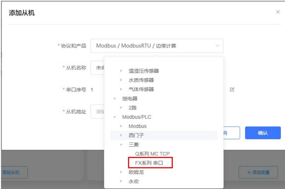
2. 选择连接 PLC 的串口号和 PLC 的站地址，输入错误可能导致采集失败。确认无误后点击确认即可。
