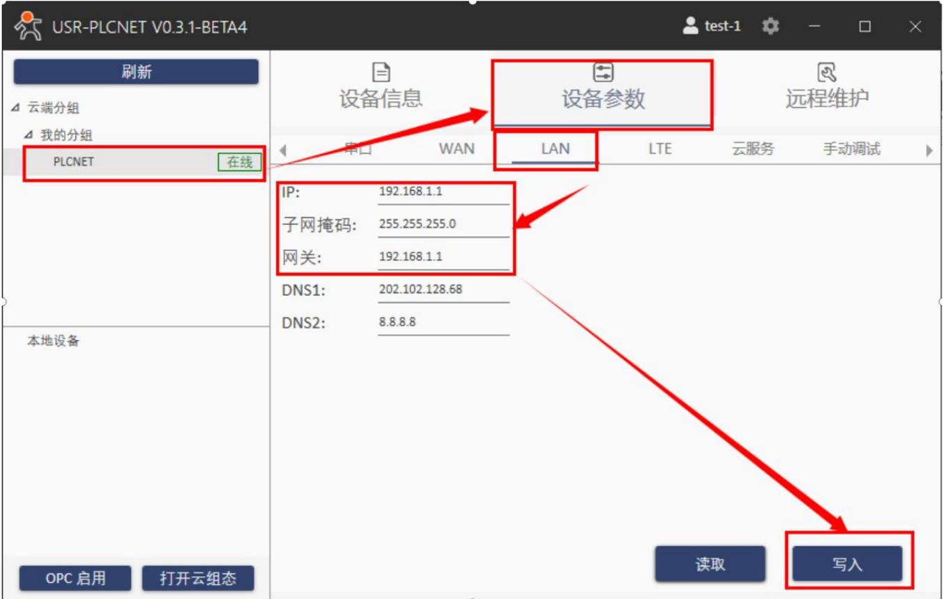
修改完成后在上位机中点击设备参数→系统参数→重启，设备重启后 LAN 口 IP 生效。
