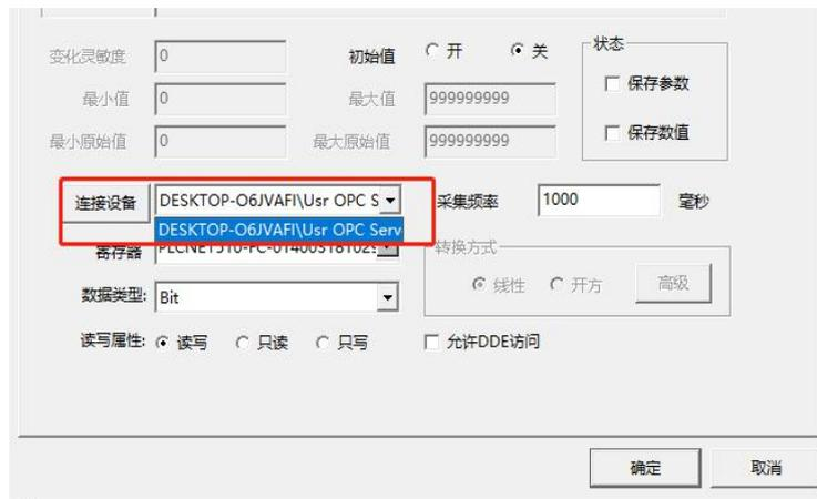
变量的寄存器为 OPC 下的一个设备，双击此设备可以显示该设备在有人云端添加的采集模板下的节点信息，通过点击这些节点信息将节点添加到组态王的寄存器，具体如下：
