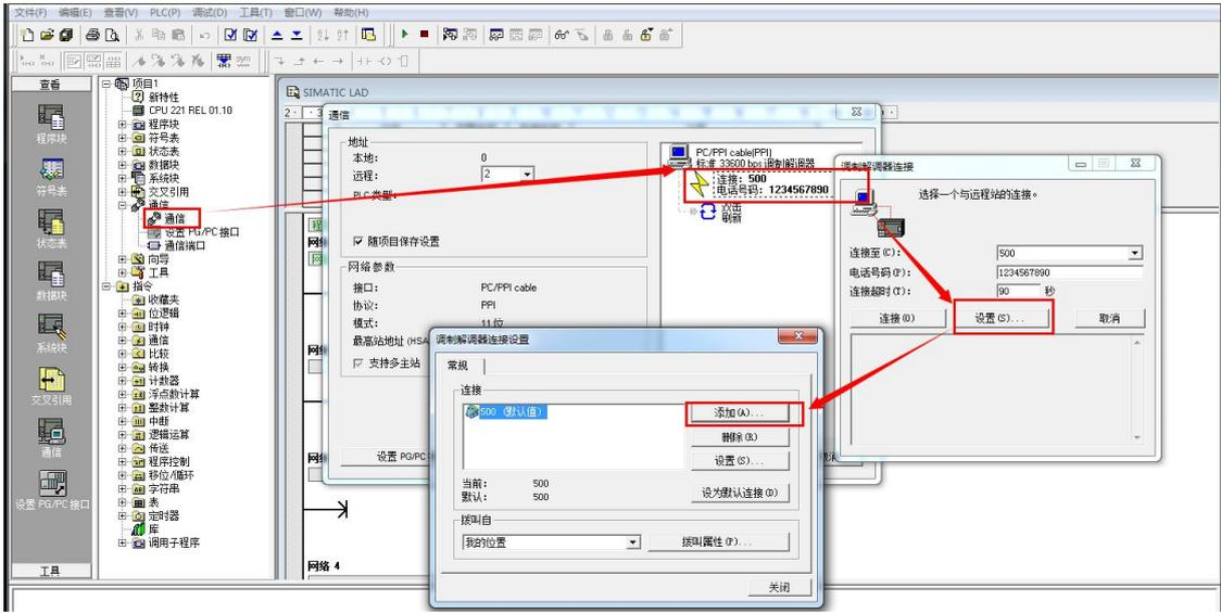
点击“添加”按钮，在弹出的对话框中输入连接名称，比如：USR-PLCNET210。本地调制解调器选择“标准 33600 bps 调制解调器”，然后勾选“这台调制解调器将使用偶校验（11 位组态）”和“将这台调制解调器用作移动电话调制解调器”。
