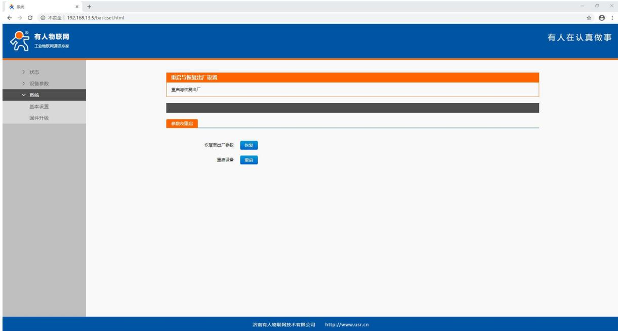
通过系统→基本设置→固件升级，可以对 PLCNET210 进行固件升级。
