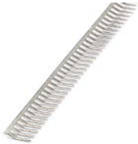
插拔式桥接件，不带绝缘，针距: 6.2 mm，长度: 616 mm，宽度: 1 mm，位数: 100，颜色: 银色/哑光
