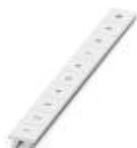
快速标记条，接头，白色，标识，适用的打印机: CMS-P1-PLOTTER，横向打印: 连续编号1 - 10、11 - 20等，直至991 - 1000，安装方式: 卡接到高型标记槽，适用的模块宽度: 10.2 mm，标识区域大小: 10.15 x 10.5 mm
