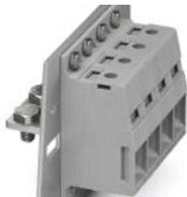
Durchführungsklemme, 接线方式: 螺钉连接, 电缆端头, 位数: 1, 负载电流: 232 A, 横截面: 35 mm<sup>2</sup> - 95 mm<sup>2</sup>, AWG 4 - 3/0, 导线连接方向与拔插方向的夹角: 0°, 宽度: 25 mm, 颜色: 黄绿相间
