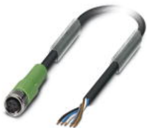
传感器/执行器电缆，5-芯，PUR，黑-灰色 RAL 7021，端自由出线，与孔式直头 M8，B编码，电缆长度: 5 m
