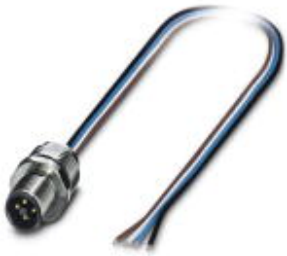
针式插座，电源，4-芯，插头，M12，T电源，板前安装，M16 x 1.5，单线，电缆长度: 0.5 m
